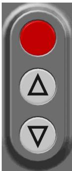
Die Störungsanzeige befindet sich unmittelbar oberhalb der Bedientaster und wird im Störfall periodisch oder permanent rot hintergrundbeleuchtet.
